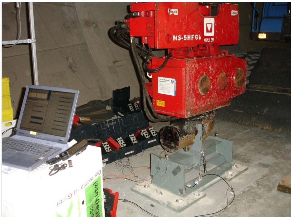
Bild 3: Rüttler und Stahljoch mit Messgerät
