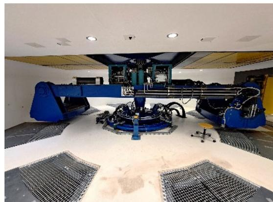
Bild 5.1b neue Zentrifuge im entkoppelten Betonzylinder
