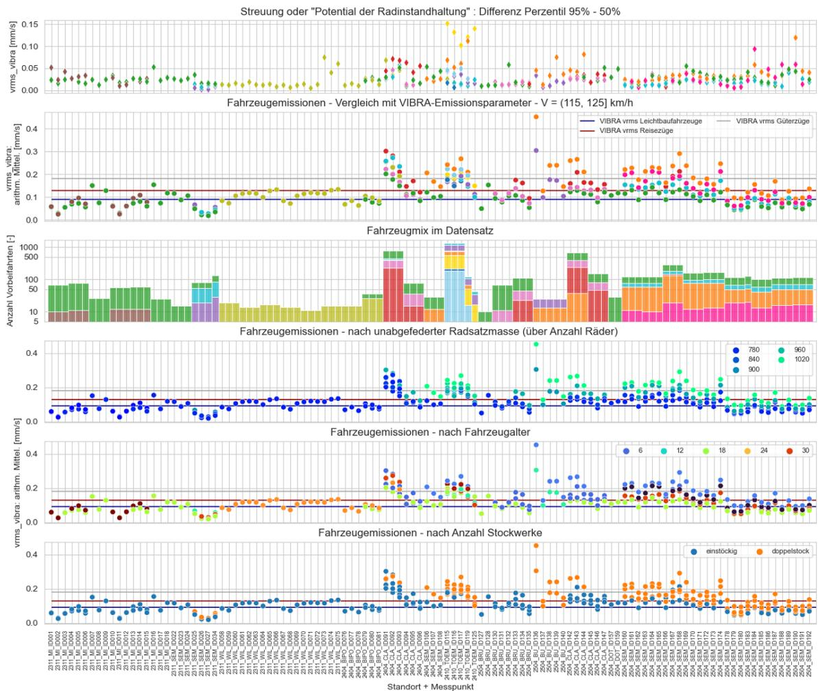
**Abbildung 6: Mittlere Fahrzeugemissionen nach Standort nach Rollmaterialtyp und Fahrzeugmerkmale, dargestellt sind nur diejenigen Fahrzeuge mit V = 115 bis 125 km/h**
