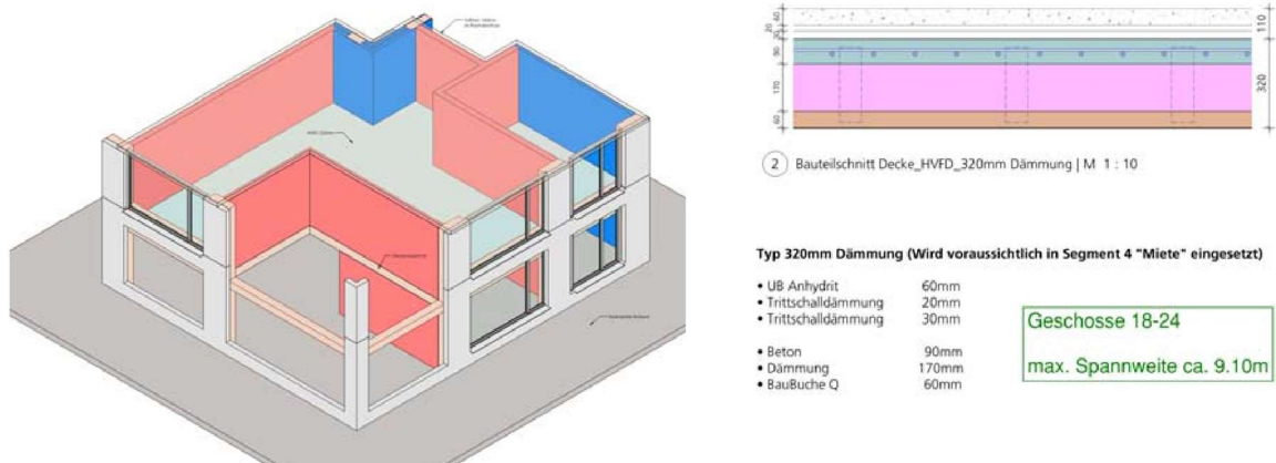
Übersicht Mock-up und Deckenaufbau
