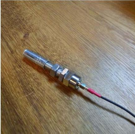
**Abbildung 2** Beispiel für einen Beschleunigungs-Sensor, montiert auf einem M10 Schraubenkopf mit Dübel Hilti HKD M10x30
