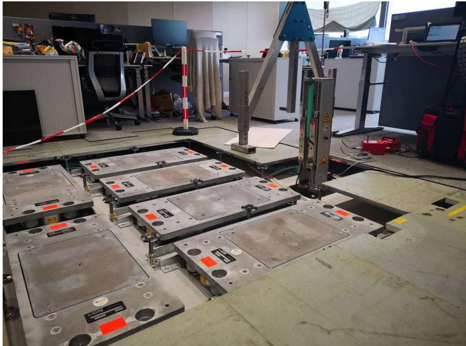
*Bild 10: Die in der Mitte eines Deckenfeldes eingebauten sechs Tilger, bei abgedecktem Hohlboden. Im mittleren Bereich rechts ist der Schwingungsgenerator Wölfel BD.5 sichtbar.*
