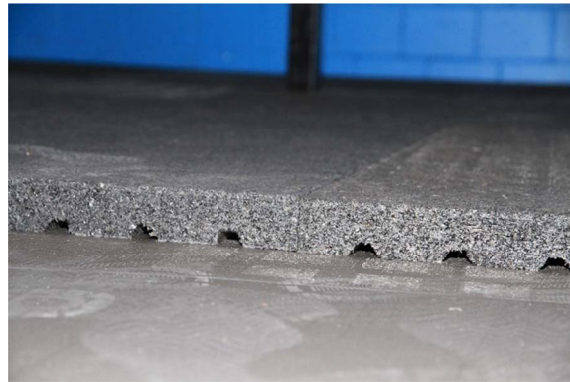
Abbildung 1, links: Anwendungsbeispiel der g-fit Bodenaufbauten (hier orange dargestellt) mit Deckschicht (schwarz) für die Nachrüstung bestehender Bodenaufbauten, zur Schwingungsisolation und zum Schutz des Bestandbodens; rechts: Handelsüblicher Sportbodenbelag aus Gummigranulat als Deckschicht
