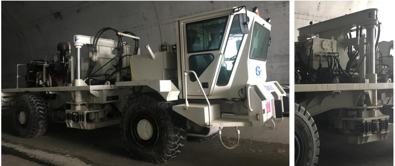
Abbildung 2 VibroScan®, Elektrohydraulischer Schwingungserreger Nomad 65
