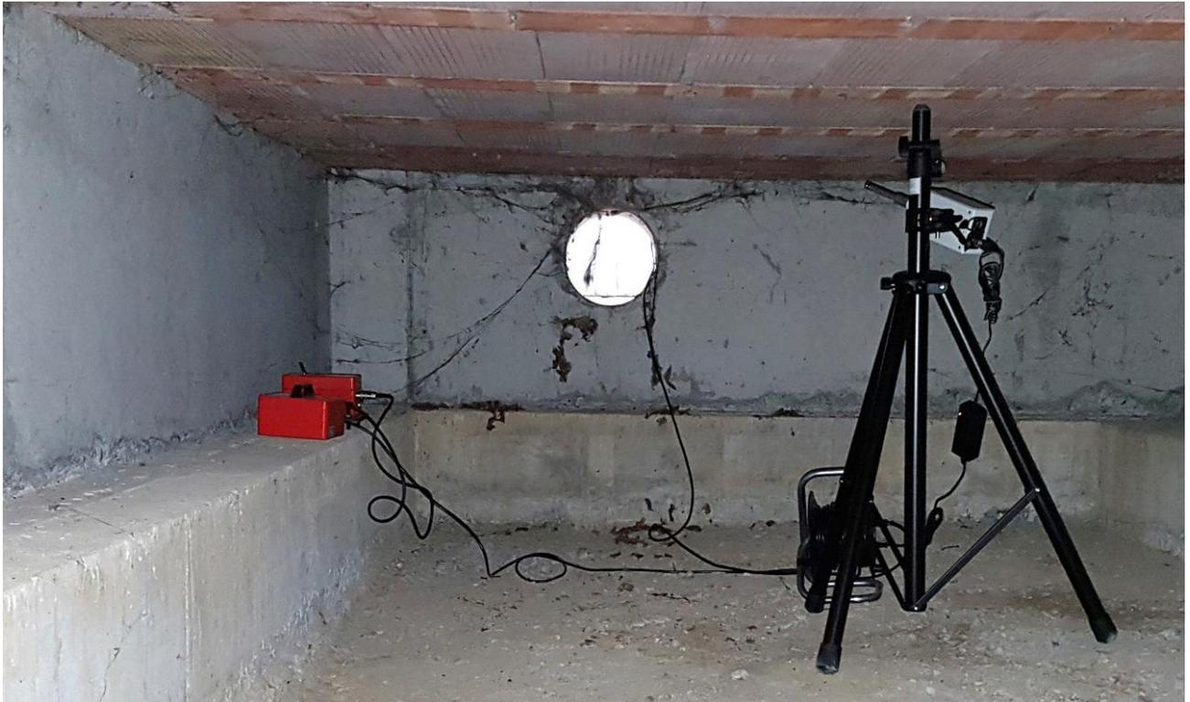
Abb. 8: Erschütterungs- und Luftschallpegelmessungen in Weinigen.
