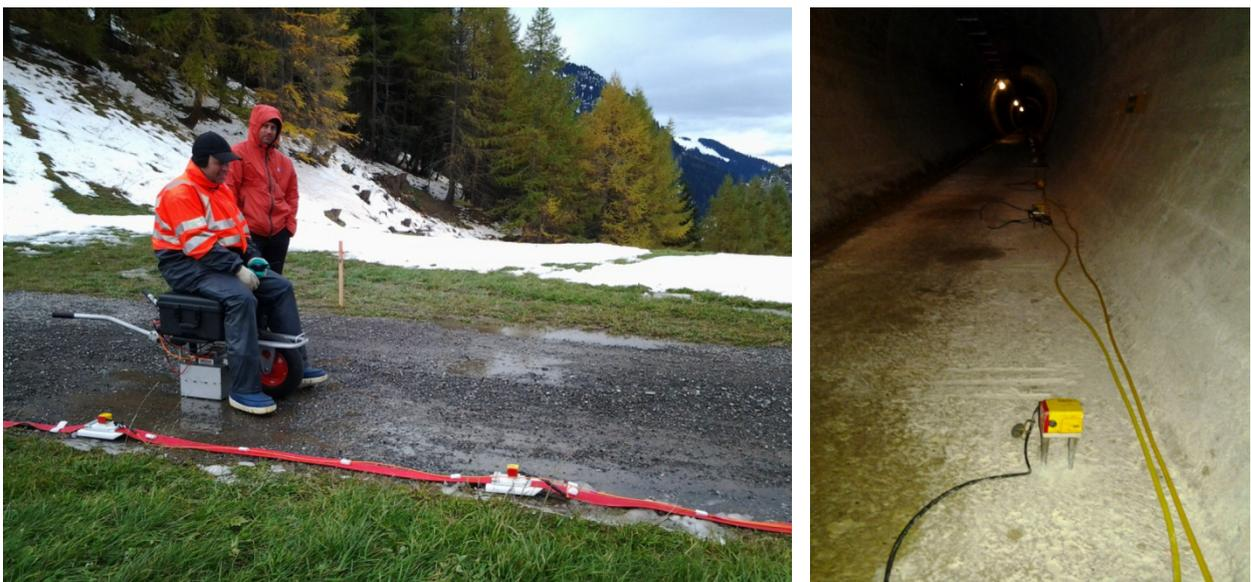
**Bild 4:** Seismisch geophysikalische Messungen, links: Anregung von Scherwellen auf der Dammkrone mit Scherwellen-Vibrator und Geophonauslage; rechts; Geophonauslage im Kontrollgang des Dammes (Keller 2012)
