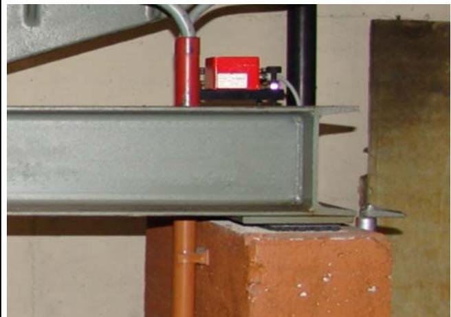
**Bild 4** Elastische Lagerung mit 10 mm Gummiplatte
