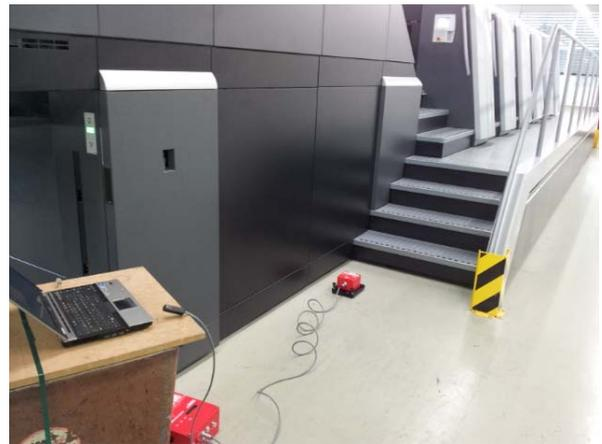
**Bild 2b** Schwingungsmessung bei der neuen Druckmaschine
