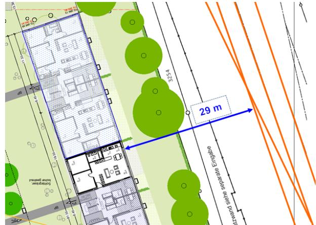
Bild 2 Situation mit Wohnhaus und Gleisanlage
