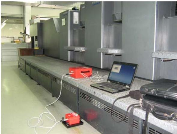
**Bild 1** Schwingungsmessung bei der alten Druckmaschine
