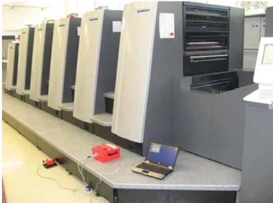
**Bild 1** Schwingungsmessung bei der neuinstallierten Druckmaschine
