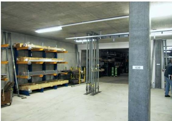
**Bild 3** Test mit 8 Baustützen in Feldmitte um die Eigenfrequenz von 14 Hz auf 18 Hz zu erhöhen
