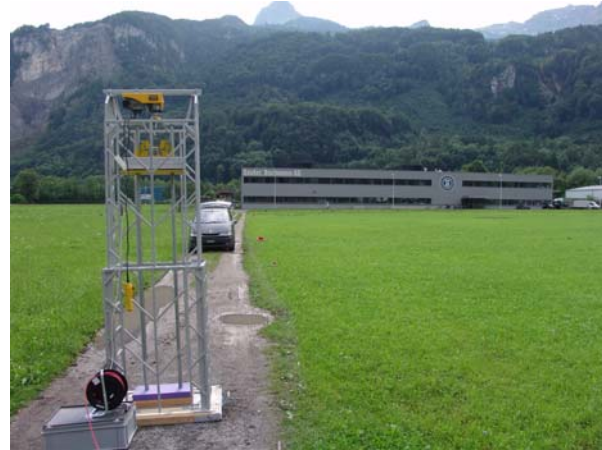
Bild 8.2 Fall-Gewicht-Anlage für die Simulation einer Stanzmaschine
