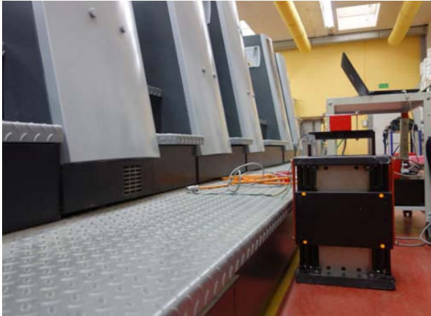
Bild 8.1 Dynamischer Erreger für die Bestimmung der harmonischen Kräfte einer Druckmaschine
