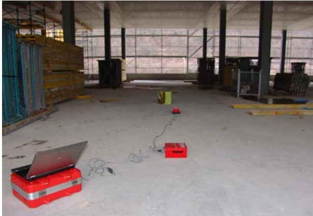
Bild 4.3 Messung der Eigenfrequenzen für eine Decke mit 7.5 m x 7.5 m Stützenraster
