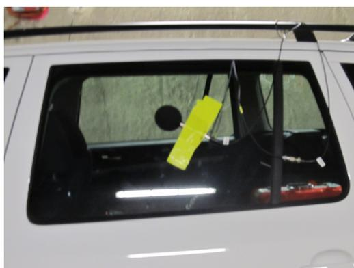
**Abbildung 8: Messungen ausserhalb des Autos. Das Mikrophon wurde am Fenster befestigt. Aus den gemessenen Daten muss man 6 dB subtrahieren, um die Reflexionen des Fensters zu kompensieren.**
