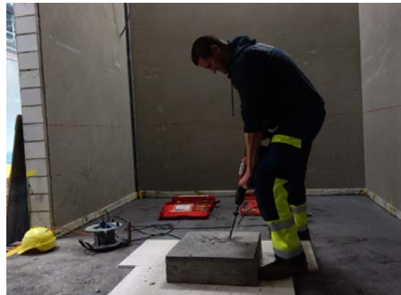
Elastische Lagerung mit zwei verschiedenen PU-Schaum-Matten mit unterschiedlichen Dicken
