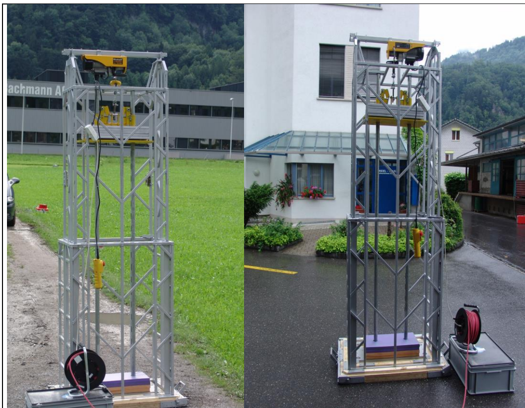
Bild 6 Impulsanlage Ziegler Consultants
