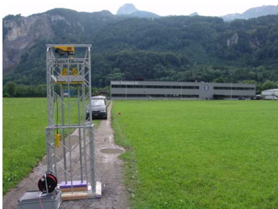
Bild 3.7 Impulsanlage: M = 150 kg, H = 2 m
