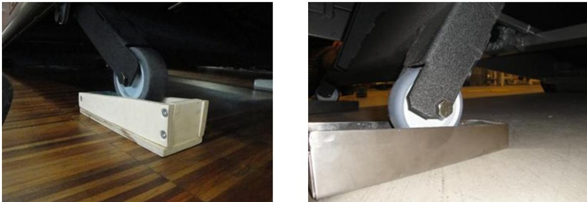
Figur 8 2 Entwicklungsstadien aus Holz und Chromstahl für Halterung von Elastomer und CYBEX, die Sylomerplatte wird jeweils in die Box eingelegt
