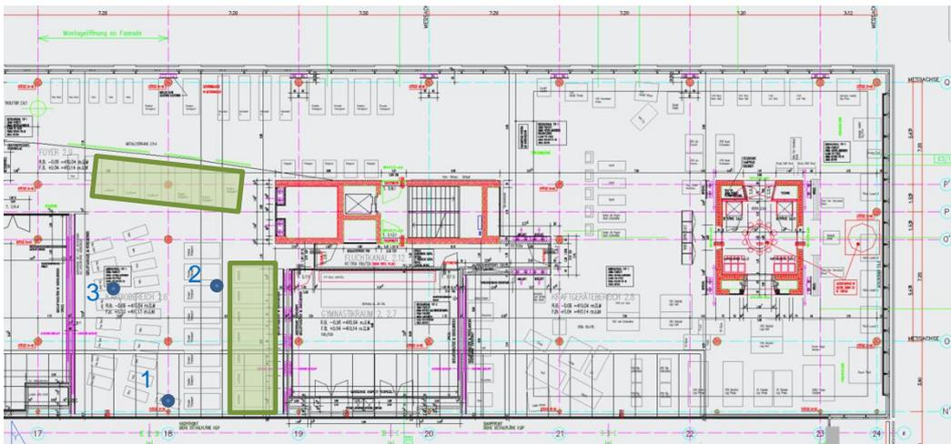
Figur 1 Grundriss 1. OG mit Fitnesscenter (grün unterlegte Bereich mit Laufbändern, blaue Kreise = Messpunkte im Erdgeschoss)
