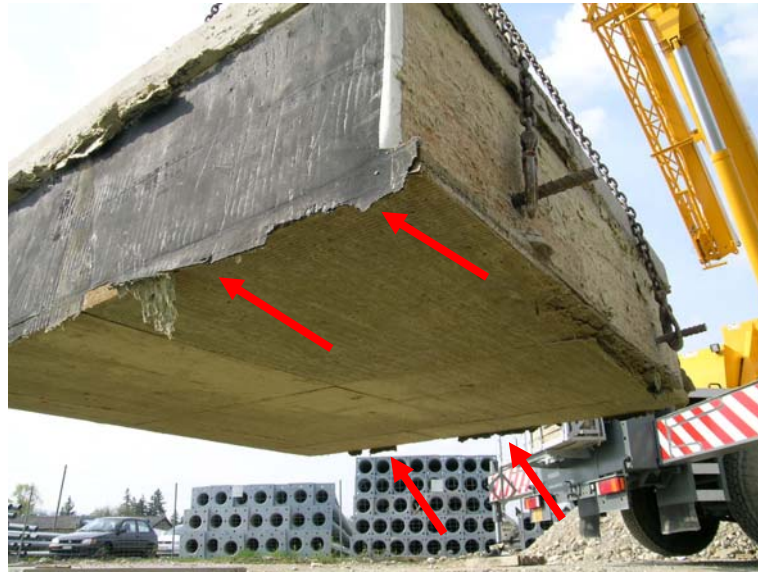
Bild 14: Abheben der Gleistragplatte des MFS B2: Im Vorder- und Hintergrund sind bituminöse Körperschallbrücken bei den im realen Gleis nicht existierenden Querfugen zu sehen.
