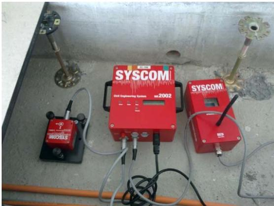
Bild 4.2-3: Ansicht der Messstation im 18. OG: Beschleunigungsaufnehmer (links), Messgerät (mitte), GPRS Router (rechts)
