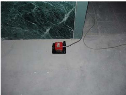
Bild 4.1-3 Ansicht eines vertikalen Sensors im Treppenhaus
