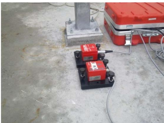
Bild 4.2-4: Ansicht der Sensoren auf dem Dach: Horizontaler Geschwindigkeitsaufnehmer (vorn) und triaxialer Beschleunigungsaufnehmer (hinten)
