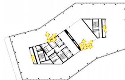
Bild 4.2-2: Situation: 3 uniaxiale Geschwindigkeitsaufnehmer und 1 triaxialer Beschleunigungsaufnehmer auf dem Dach. 1 triaxialer Beschleunigungsaufnehmer (oben) bei Er-schliessungskern im 18. OG
