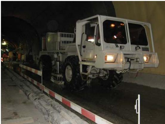
**Bild 5.1** Schwingungsgenerator P23
