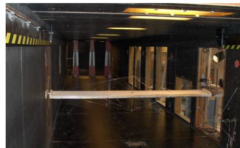
Bild 5: Links: erster untersuchter Querschnitt der Seebrücke. Rechts: Section-Modell im Windkanal.
