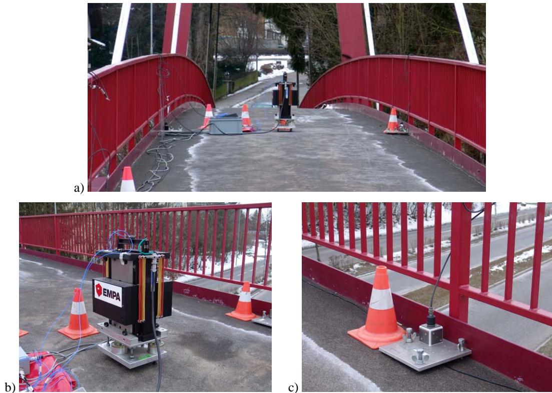
Abb. 8: a) Schwingungserreger in der Mitte und Beschleunigungsaufnehmer auf beiden Seite der Gehplatte. b) Schwingungserreger. c) Beschleunigungsaufnehmer.
