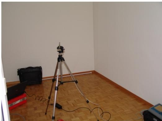
Bild 2.1.4-5 Ansicht des vertikalen Sensors im 7. OG in Deckenmitte
