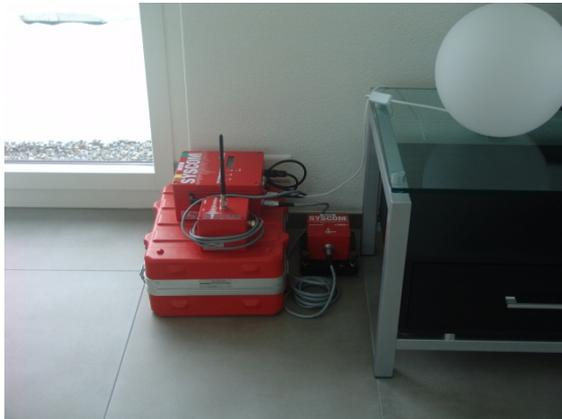
Bild 2.1.5-4 Ansicht des triaxialen Sensors am Deckenrand im 5. OG
