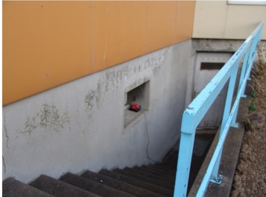
Bild 2.1.4-4 Ansicht des vertikalen Sensors am Fundament
