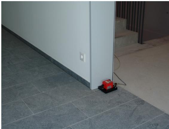
Bild 2.1.3-4 Ansicht eines vertikalen Sensors im Treppenhaus
