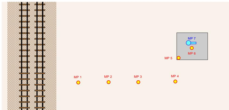
**Bild 3.1b** Anordnung der Aufnehmer im Grundriss
