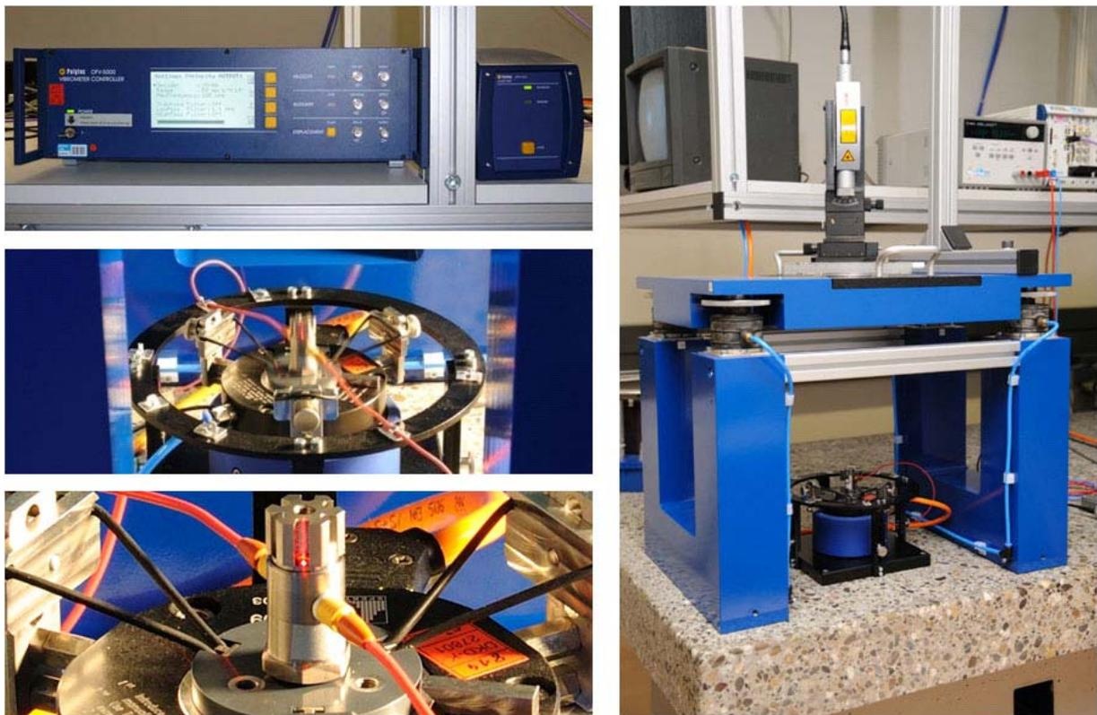
*Fig. 6: Ansicht des Messaufbaus für die Primär-Kalibrierung. Auf der Übersichtphoto rechts sieht man den Laser-Kopf des Vibrometers, welcher auf einer Vibrationsisolation montiert ist. Auf der linken Seite ist ganz oben der Vibrometer-Controller und die Laser-Einheit abgebildet. Links unten sieht man Detail-Aufnahmen des HF-Shakers mit montiertem Prüfling - hier ein zu kalibrierender Impedanzmesskopf.*
