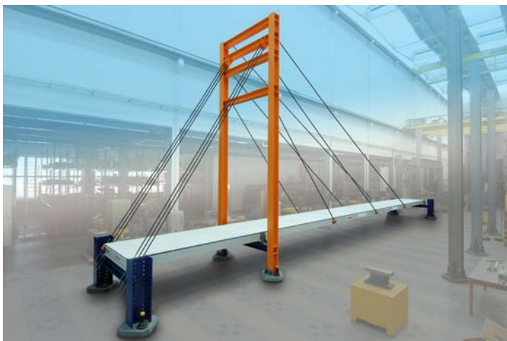
Abb. 1: Gesamtansicht der Laborbrücke (mit GFK Brückendeck)
