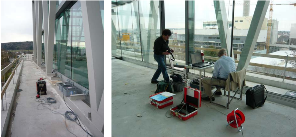
Abb. 6 Schwingungsmessungen (linke Seite: Shaker auf Fluchtbalkon, Messpunkt 1)
