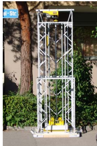
Bild 3.1b Fallgewicht Fallhöhe: 2m Gewicht: 100 kg
