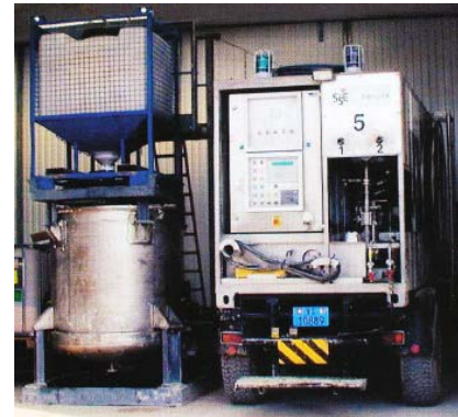
Pumpfahrzeug für Emulsionssprengstoff, volle Ausnützung des Bohrlochdurchmessers, Bohrloch auf ca. 2/3 Länge gefüllt
