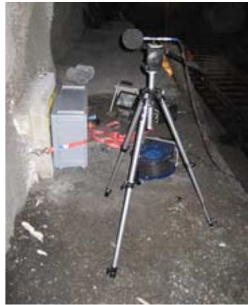
kombinierte Erschütterungs- und Schallmessung
