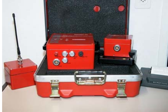
Bild 4 - MR2002-CE Standard Set mit Triaxial-Sensor von Syscom
