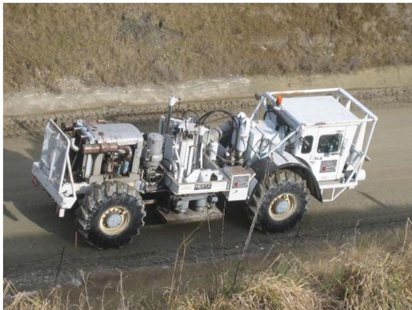
**Abbildung 1:** VibroScan<sup>®</sup> Schwingungsgenerator
