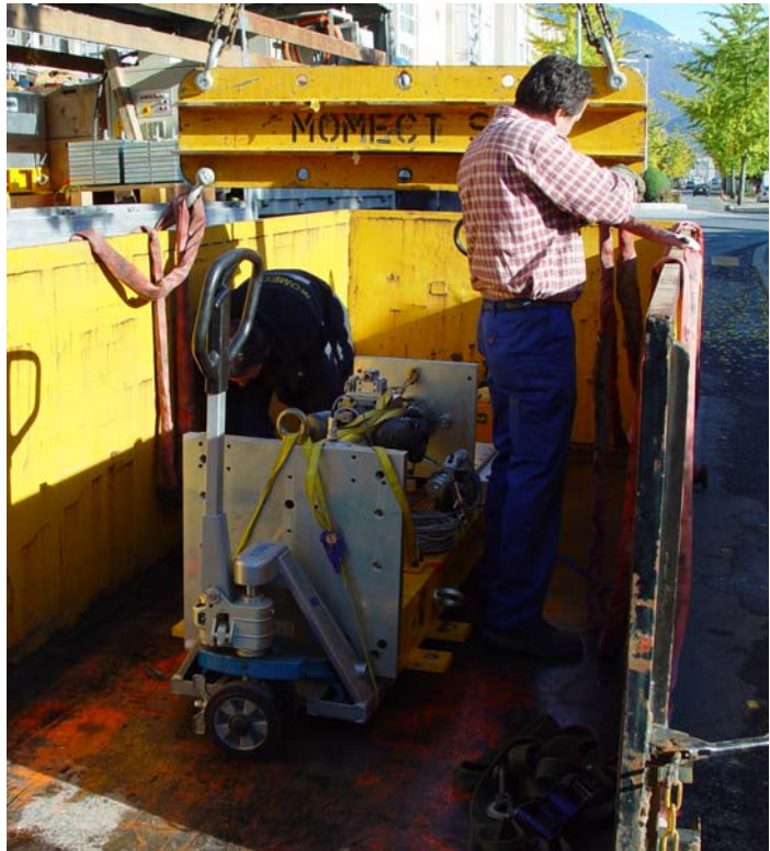
Abbildung 4: Kranwagen, welcher die Mulde mit Schwinger ans Haus hebt (links) und Schwinger in Mulde (rechts).
