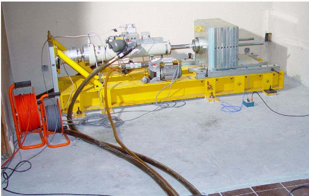
Abbildung 3: Hydraulischer Schwinger mit 500 kg Masse auf Schlitten, fixiert auf gelbem Montagegerüst.
