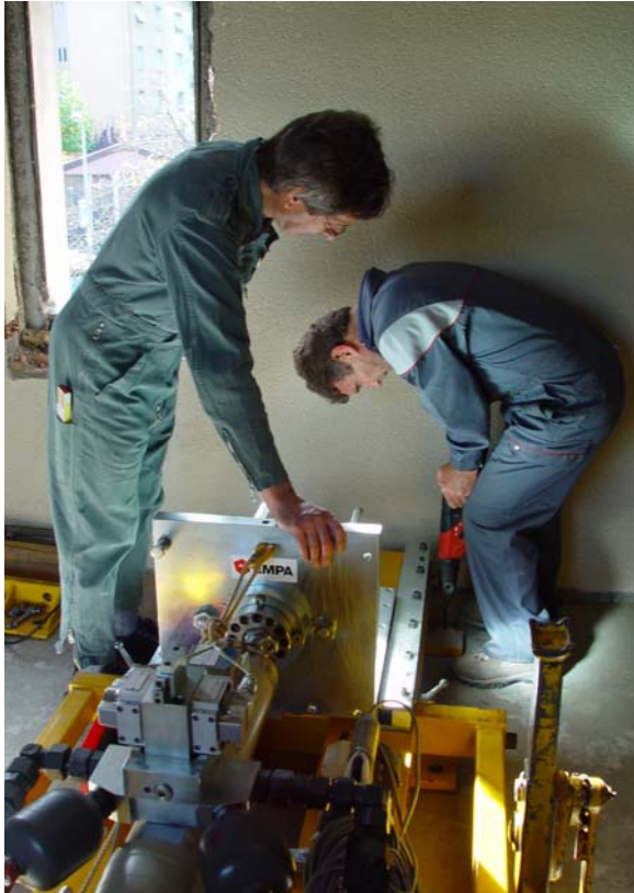
Abbildung 6: Bohren der Löcher für die Montage des Schwingers (links) und Messstation mit Control-Tower für Wegregelung beider Schwinger.
