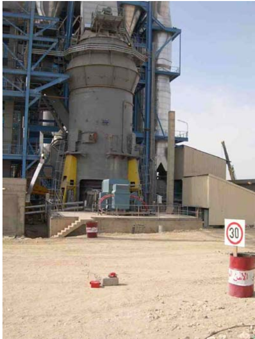
Bild 5: Messen der Vibrationen in einem Abstand zur Mühle
