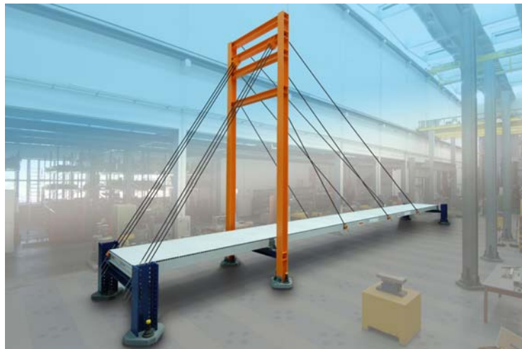
Abb. 1: Fussgängerbrücke in der Bauhalle der Empa in Dübendorf. Die 20 m lange Brückenplatte besteht aus pultrudierten GFK-Profilen, wodurch eine äusserst leichte Konstruktion resultiert.
