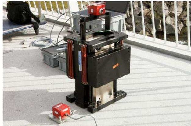
**Bild 9.5b** Schwingungsmessung mit Geländer
