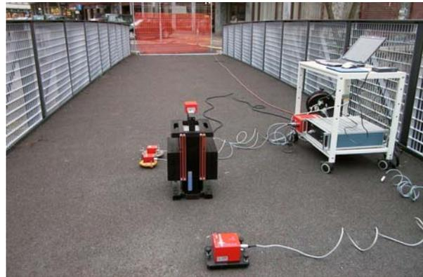
Bild 6.1b Schwingungsmessung
