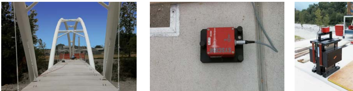
Figure 4.3: Capteur de vitesse et de déplacement / accéléromètre triaxial / excitateur
