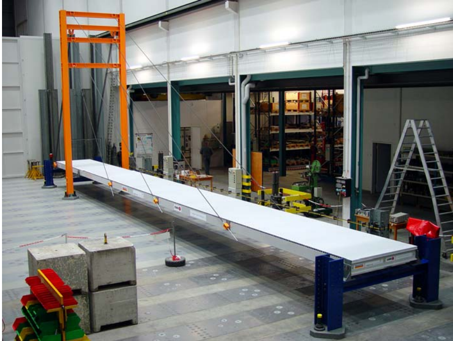
Abb. 1 – Schrägseil Fussgängerbrücke in der Bauhalle der EMPA.
