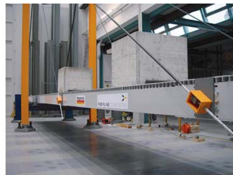
Abb. 4 – Erster Belastungstest der Brücke mit vier Betonquadern von je einer Tonne. Links sind die berechneten Verformungen der Struktur dargestellt. Die maximale berechnete Durchbiegung beträgt \delta_5 = 25.6 mm, gemessen wurden 28.5 mm.
