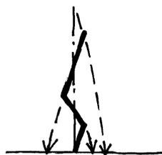
Bis jetzt wurden in Deutschland 21 Stahlbetonschornsteine mit Höhen zwischen 80 m und 300 m erfolgreich mit einer Mehrfachsprengung zusammengefallen. In der Schweiz wurde ein Schornstein in Liesberg mit einer Mehrfachsprengung verkürzt niedergebracht.
