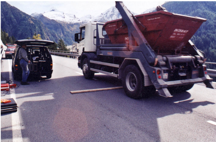
Abb. 3-2 LKW-Fahrt über ein Brett zur Bestimmung der dynamischen Durchbiegung
