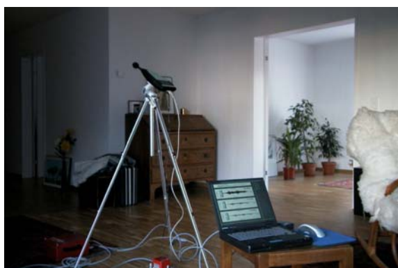
Bild 2.4a Synchroner Messung von Erschütterung und Körperschall
