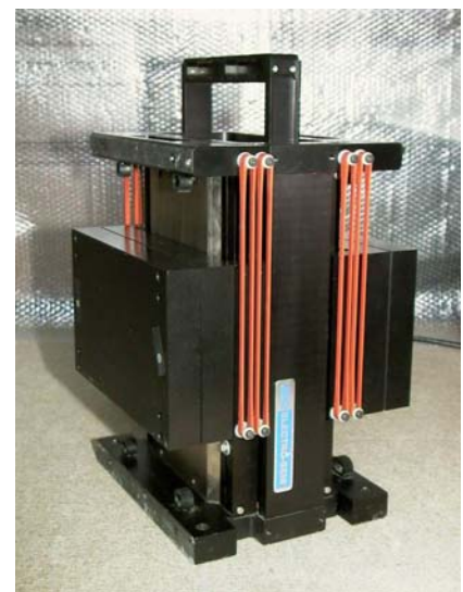
Bild 2.1 Elektrodynamischer Erreger von APS
