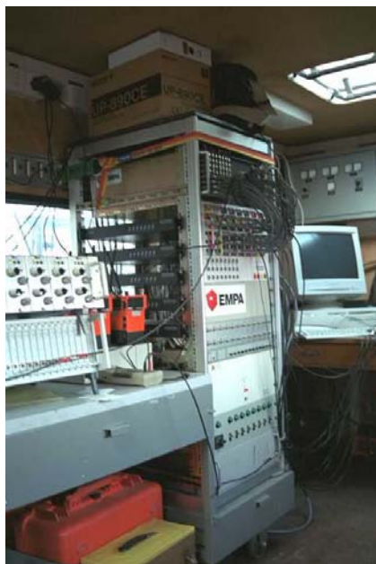
Abb. 16: Links: Datenerfassungsanlage mit 32 Kanälen im Messwagen. Rechts: Servo-hydraulischer Schwingungserreger.
