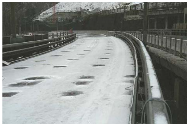
Abb. 15: Links: Messgitter der experimentellen Modalanalyse. Rechts: Verschneite Fahrbahn der Brücke mit den freigelegten Messstellen.
