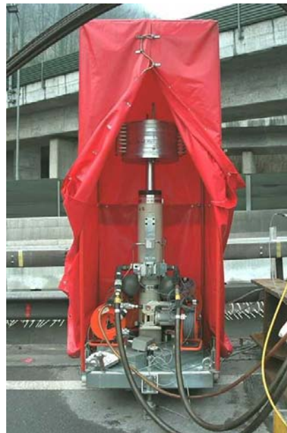
Abb. 16: Links: Datenerfassungsanlage mit 32 Kanälen im Messwagen. Rechts: Servo-hydraulischer Schwingungserreger.
