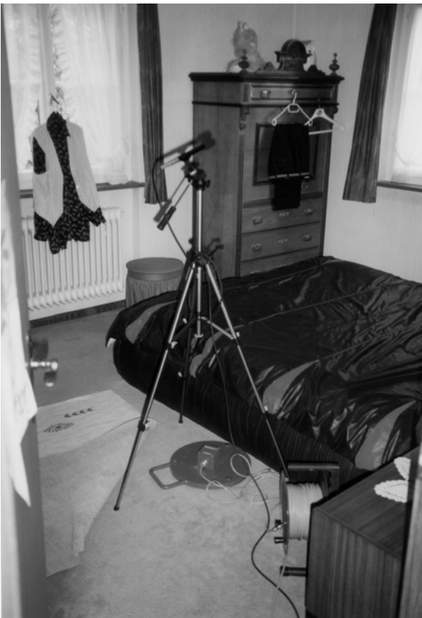
Bild 4: Beispiel für Messstelle „Erdgeschossboden“ (Messrichtung Vertikal)
