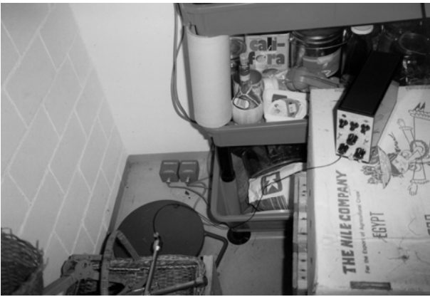
Bild 3: Beispiel für Messstelle „Gebäudefundament“ (Messrichtungen Vertikal und Horizontal)
