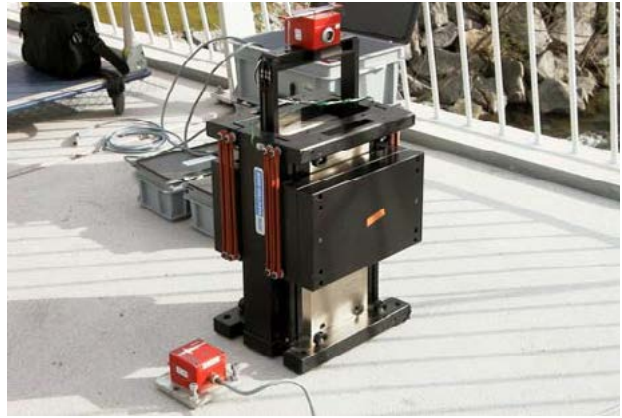
Bild 9.16b „Forced vibration“ Anregung mit einem elektrodynamischen Erreger.
