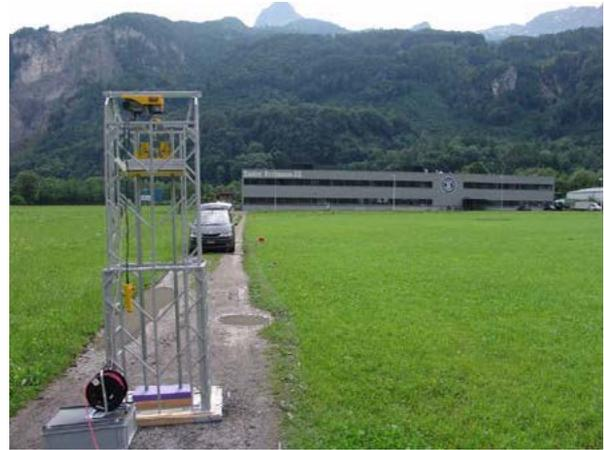
**Bild 8.2** Fall-Gewicht-Anlage für die Simulation einer Stanzmaschine
