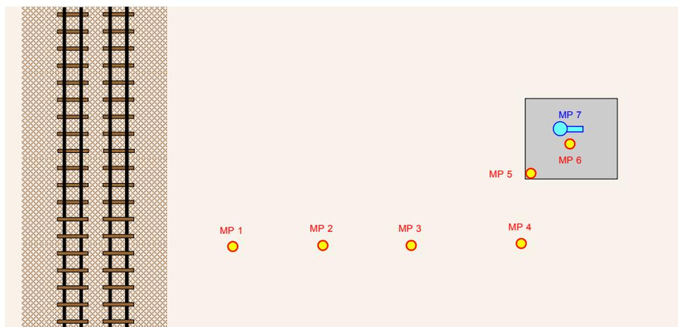
**Bild 3.1b** Anordnung der Aufnehmer im Grundriss
