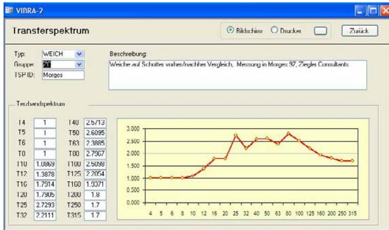
**Bild 4.12** Transferspektrum für den Einfluss einer Weiche
