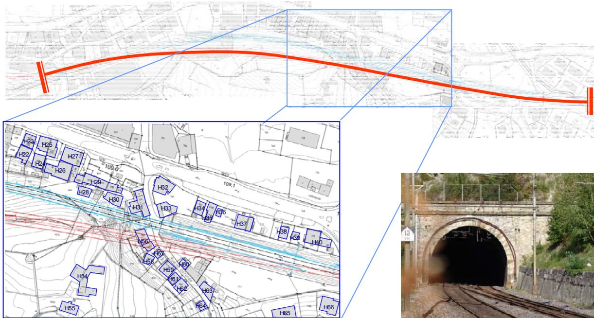
**Bild 6.1** Neuer Tunnel von Sierre: Rot = neue Linienführung
