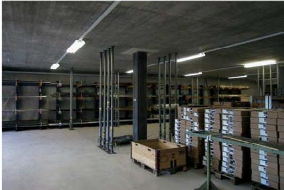
**Bild 1** Versuche mit Baustützen, um eine Reduktion der Spannweite zu simulieren
