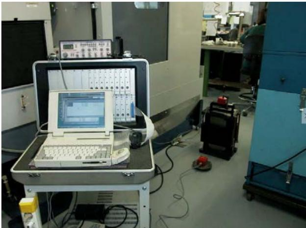
Bild 1 Schwingungsmessungen zwischen zwei Bearbeitungszentren
