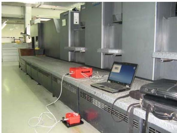
Bild 1 Schwingungsmessung bei der alten Druckmaschine
