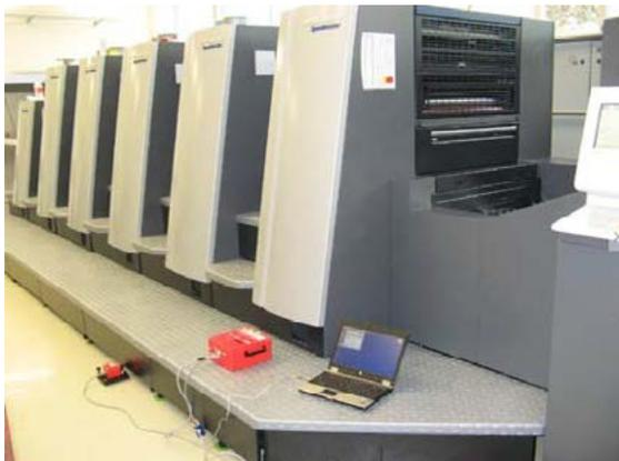
**Bild 1** Schwingungsmessung bei der neuinstallierten Druckmaschine
