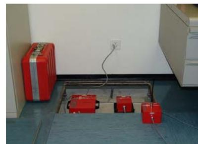
**Abb. 3.6c:** Messpunkt auf Betonboden bei aufgeständertem Boden
